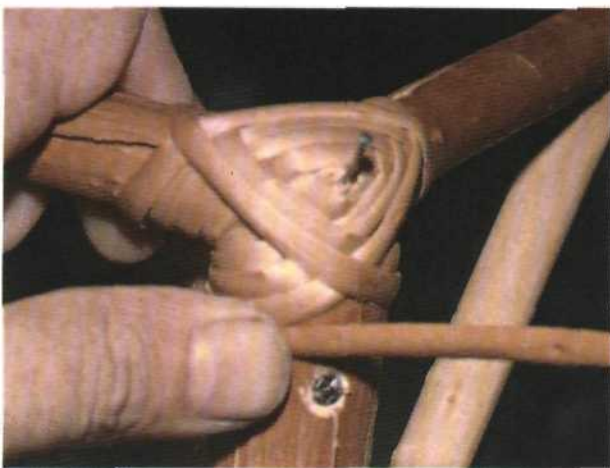
Рис. 294. Завершение обматывания переднего угла сиденья
