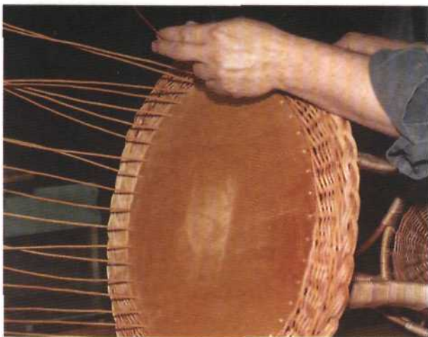
Рис. 344. Размещение прутьев в сквозных отверстиях столешницы
