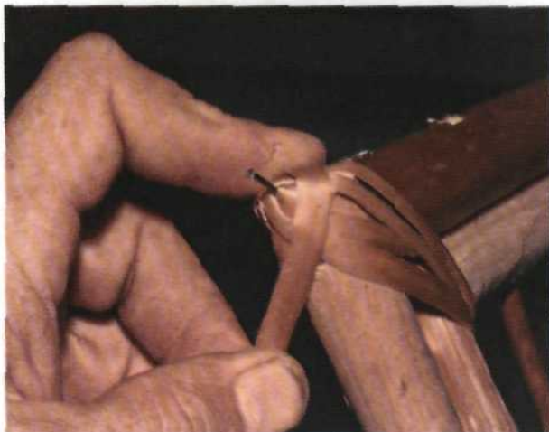
Рис. 290. Продолжение обматывания лентой угла спинки
