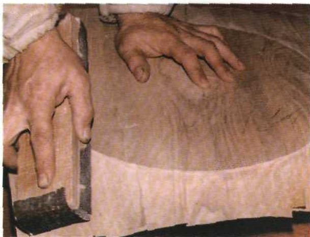
Рис. 37. Стачивание шпона, выступающего за край фанерной заготовки
