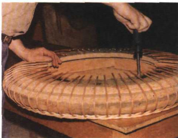
Рис. 335. Разборка формы после выдерживания стоячков 12 ч в загнутом положении
