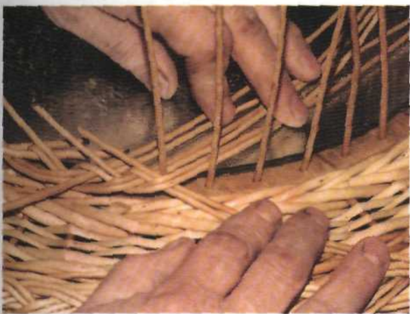
Рис. 225. Протягивание третьей пары прутьев поверх четвертой пары
