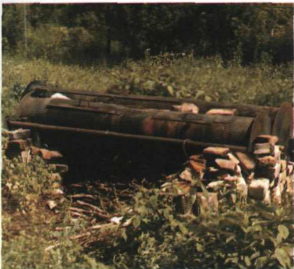
Рис. 3. Дровяной котел для отваривания прута
