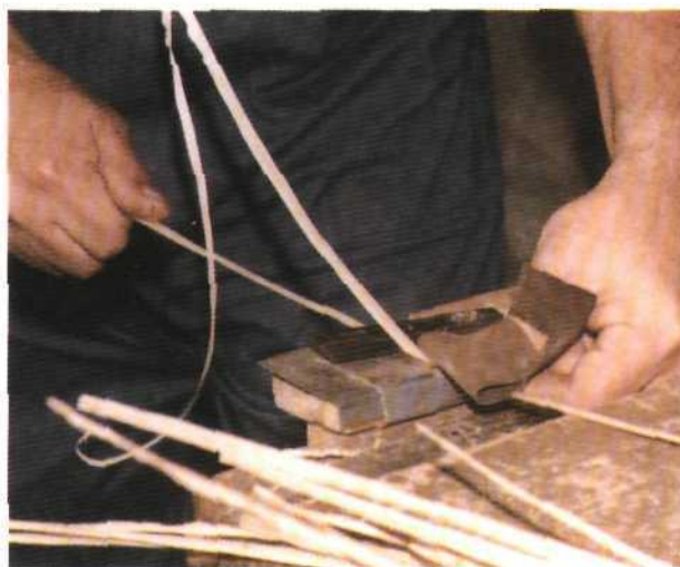
Рис. 19. Строгание шины шофом
