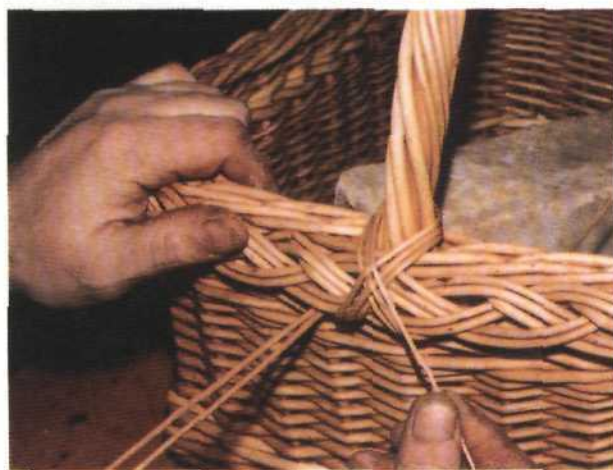
Рис. 128. Охватывание ручки концами прутьев
