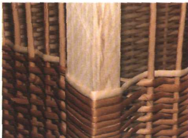
Рис. 170. Обвивка боковой рейки при выходе ленты наружу плетения
