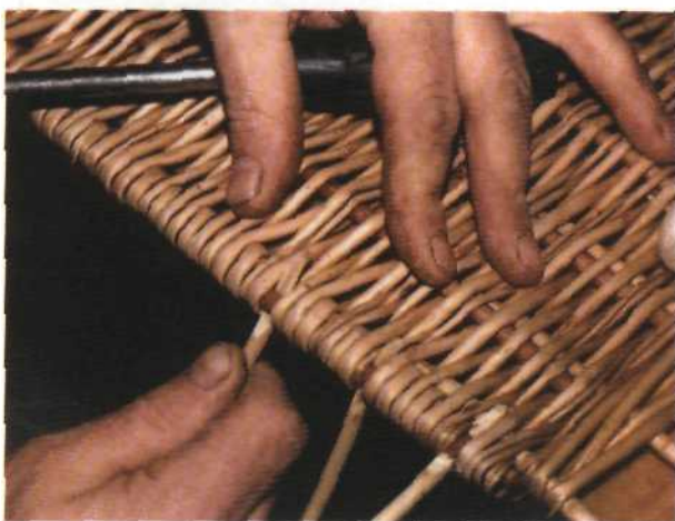
Рис. 116. Втыкание стоячков боковых стенок в расщепленные палочки
