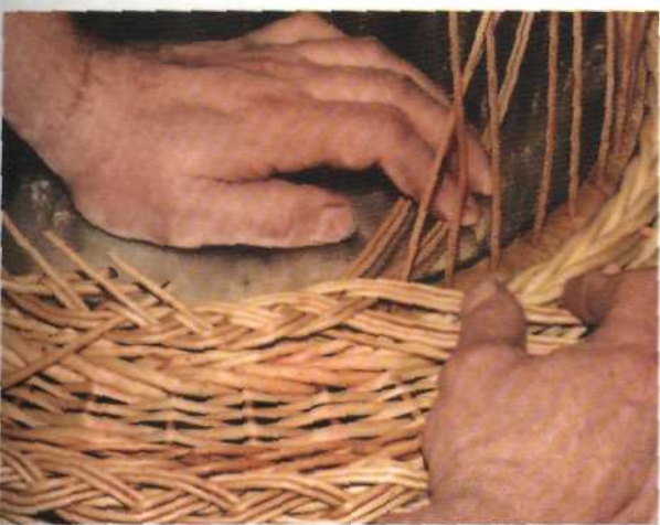
Рис. 226. Плетение косички с загибкой пятого, шестого и седьмого стоячков
