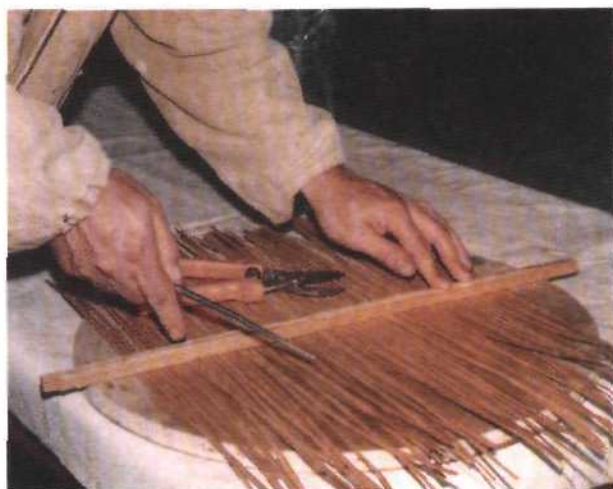
Рис. 261. Укладывание лент на фанерный круг-основу под рейку
