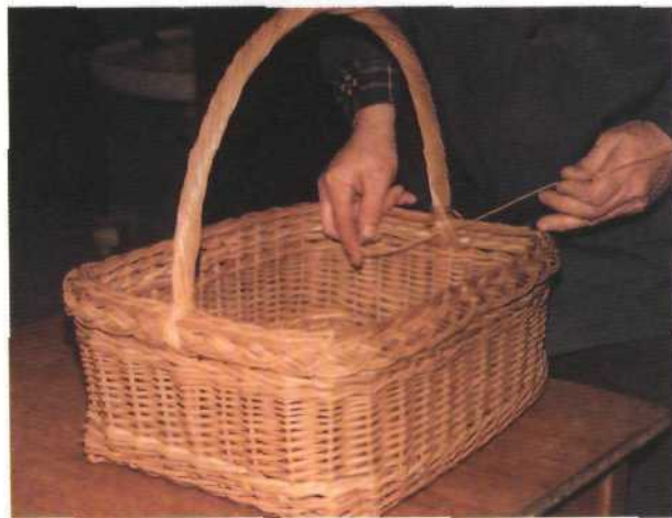
Рис. 131. Выдергивание конца прута под узел
