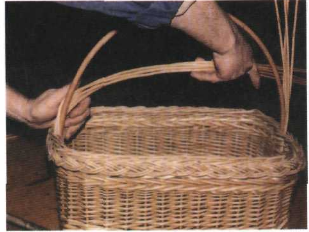
Рис. 125. Начало обматывания палки для ручки пучком прутьев
