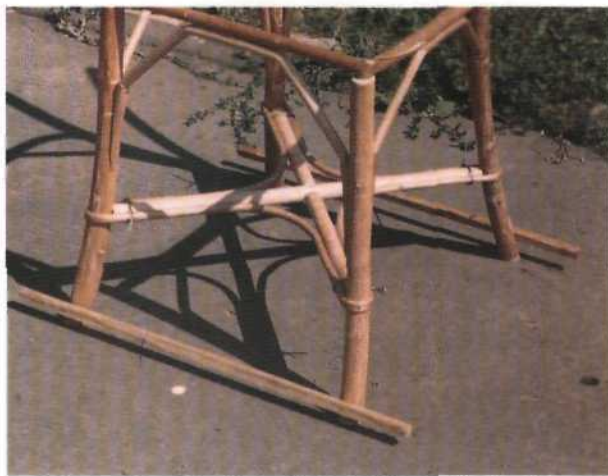
Рис. 282. Временное фиксирование рейками положения ножек стула в каркасе
