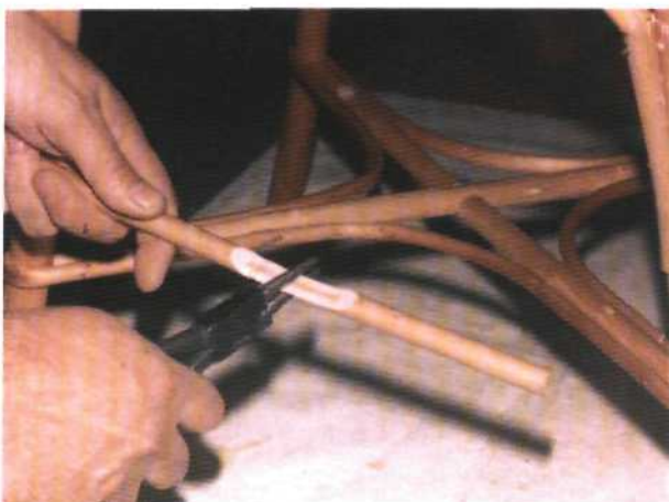
Рис. 281. Проминание круглогубцами упора перед установлением на каркас
