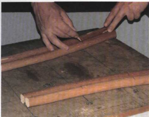
Рис. 279. Разметка ножек стула на специальной планшете
