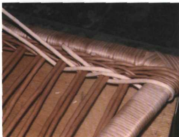
Рис. 301. Начало плетения веревочки из трех белых прутьев на спинке стула
