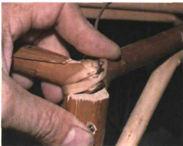
Рис. 293. Продолжение обматывания переднего угла сиденья
