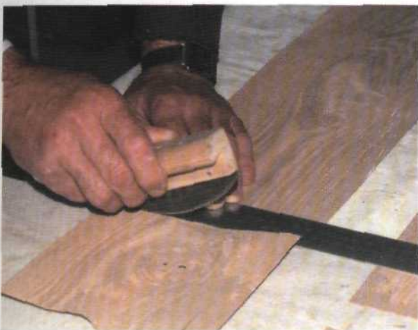
Рис. 31. Нарезание полос шпона резакром с зубчиками
