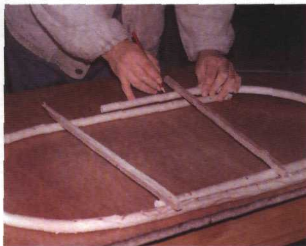
Рис. 319. Стыковка двух полуовалов с зарезанием концов палок “на ус”
