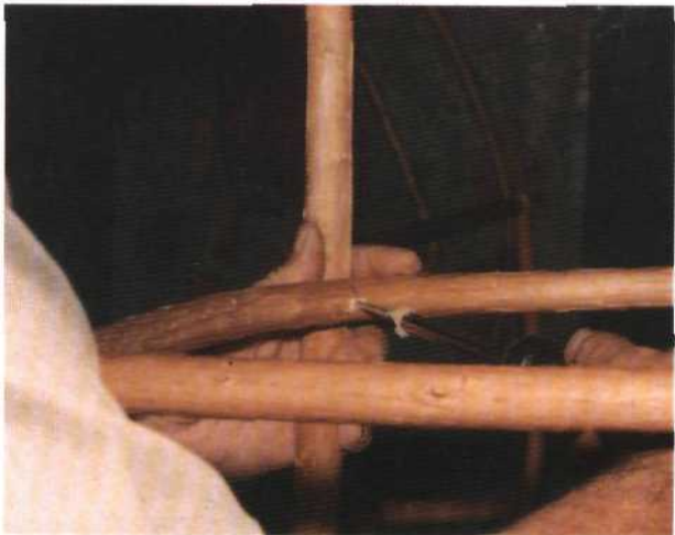
Рис. 309. Прикрепление сиденья шурупами к задним ножкам
