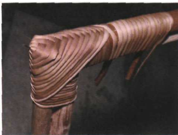
Рис. 291. Начало обматывания каркаса спинки от оплетенного угла
