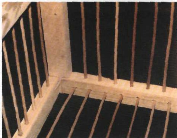
Рис. 166. Схема расположения стоячков в рейках каркаса
