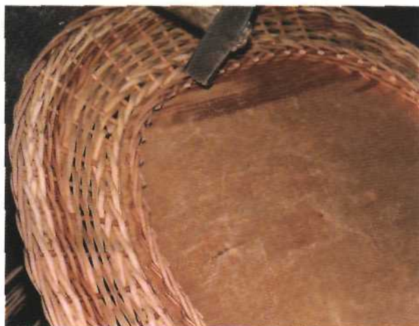
Рис. 221. Уплотнение молоточком загибки стоячков (с изнаночной стороны)
