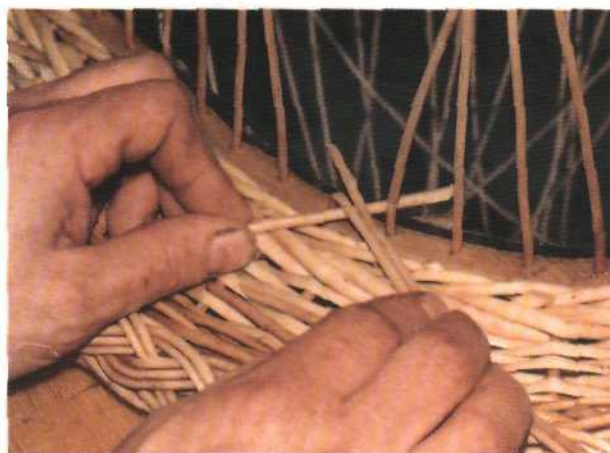
Рис. 222. Загибка первого стоячка через палочку в паре с дополнительным прутком
