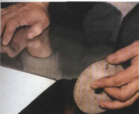
Рис. 206. Заглаживание обрезанных углов зеркала точильным камнем
