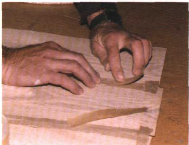
Рис. 33. Проклеивание стыков шпона липкой бумагой
