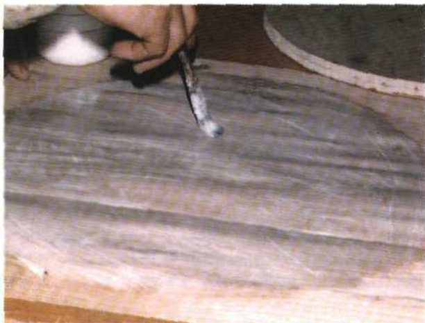
Рис. 34. Нанесение клея ПВА на поверхность шпона
