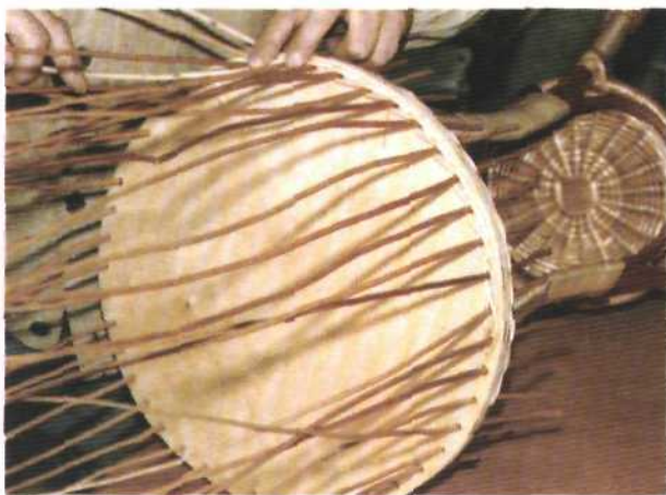
Рис. 253. Размещение стоячков в сквозных отверстиях круга-основы
