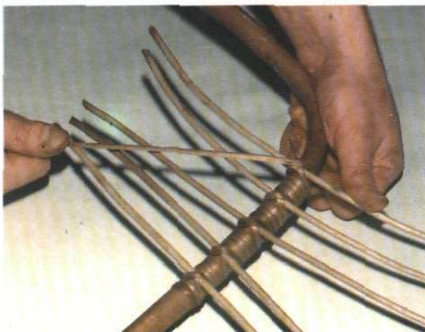
Рис. 233. Обматывание лентой обода с прибитыми к нему прутьями
