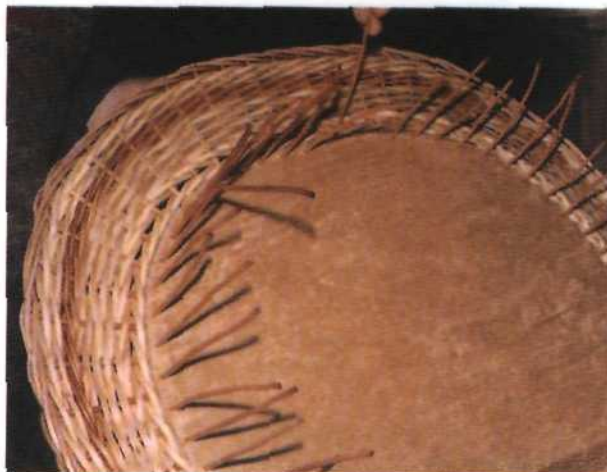
Рис. 218. Размещение стоячков в фанерной основе (вид с изнаночной стороны)
