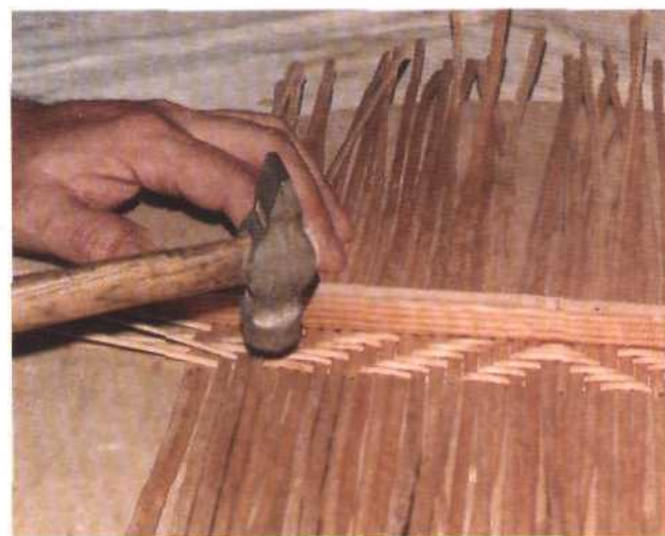
Рис. 264. Прикрепление полотна из лент к фанерному кругу-основе
