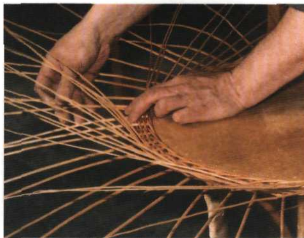
Рис. 341. Выполнение послойного плетения по воткнутому в торец столешницы стоячкам
