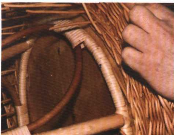
Рис. 346. Загибка стоячков за один стоячок внутрь под столешницей
