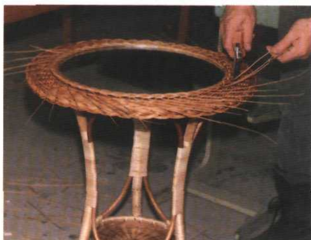
Рис. 349. Обрезка прутьев, торчащих из плетения косички
