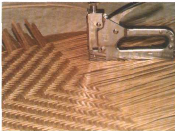
Рис. 265. Законченная первая половина ленточного полотна
