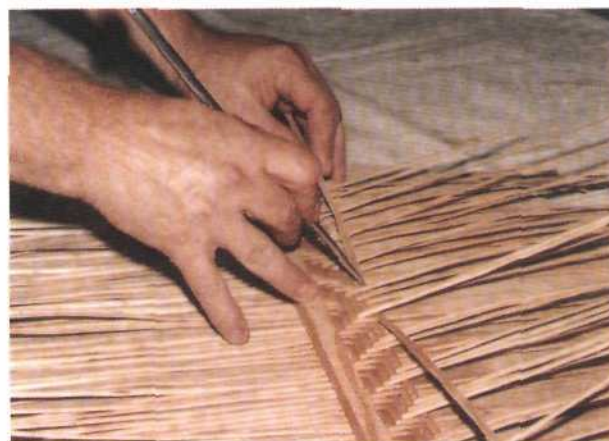
Рис. 263. Протягивание седьмой ленты в процессе плетения ленточного полотна
