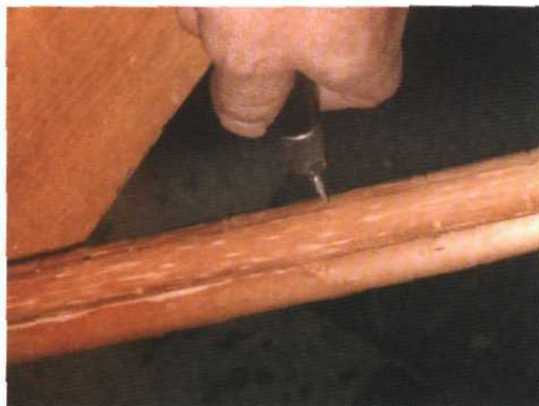
Рис. 288. Разметка трехгранным шилом отверстий на верхней поперечине спинки
