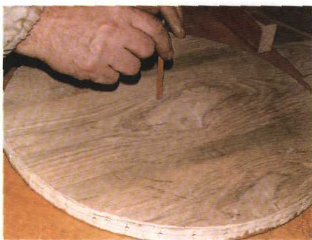
Рис. 38. Простукивание поверхности приклеенного шпона карандашом
