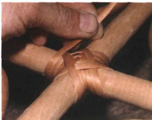
Рис. 286. Плетение лентой "звезды" на нижней крестовине каркаса
