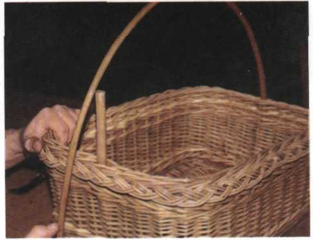
Рис. 124. Установка палки для ручки
