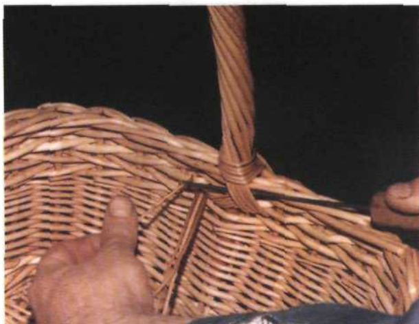
Рис. 130. Захватывание прошивкой конца прута обмотки ручки
