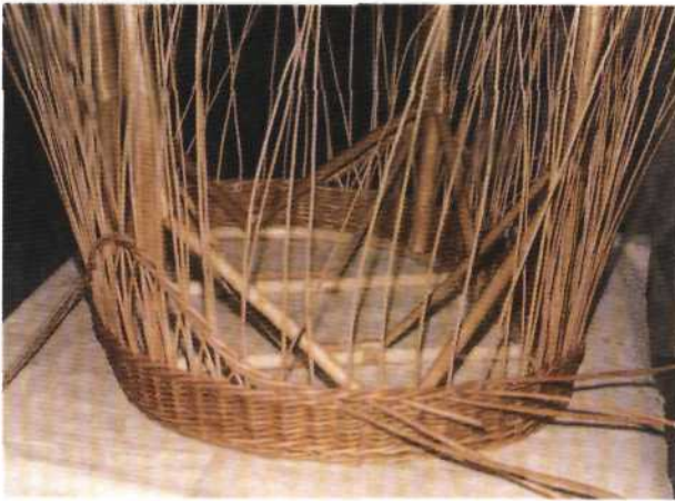
Рис. 323. Размещение дополнительных стоячков и плетение крестообразного ажюра
