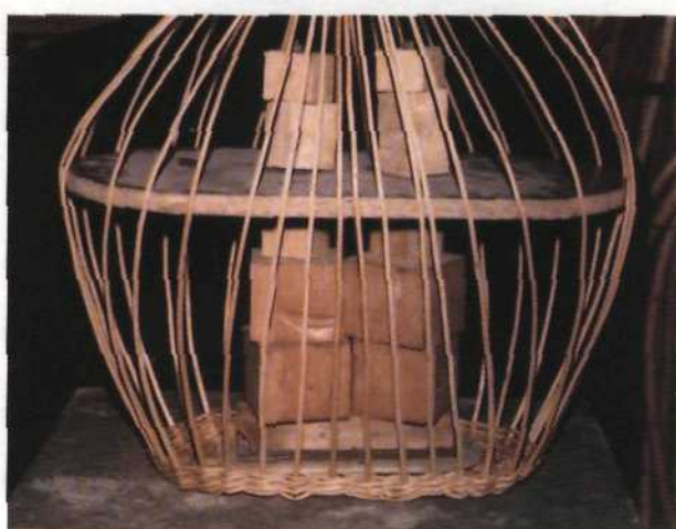
Рис. 98. Размещение формы внутри плетения (ее можно прибить вместе с дном к столу)
