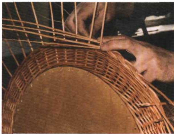
Рис. 343. Выполнение загибки стоячков с плетением косички в три пары прутьев по краю
