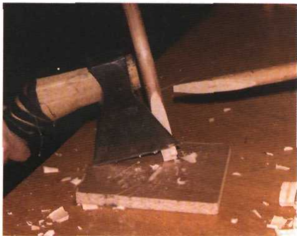
Рис. 311. Срезание "на ус" топором концов палок каркаса
