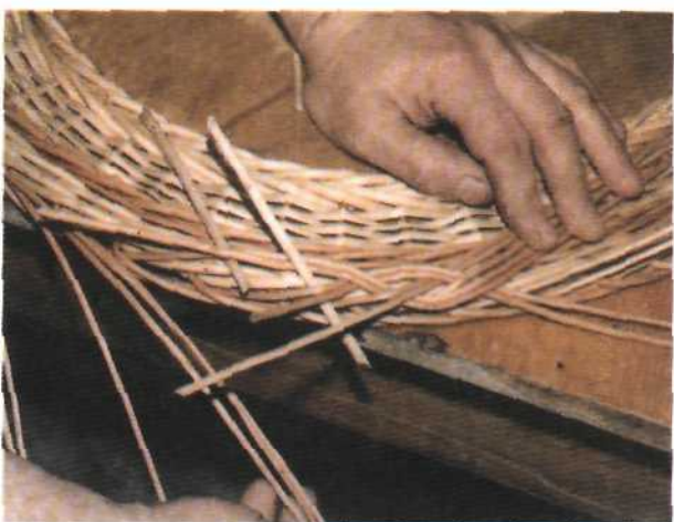
Рис. 214. Начало плетения косички по окружности рамы
