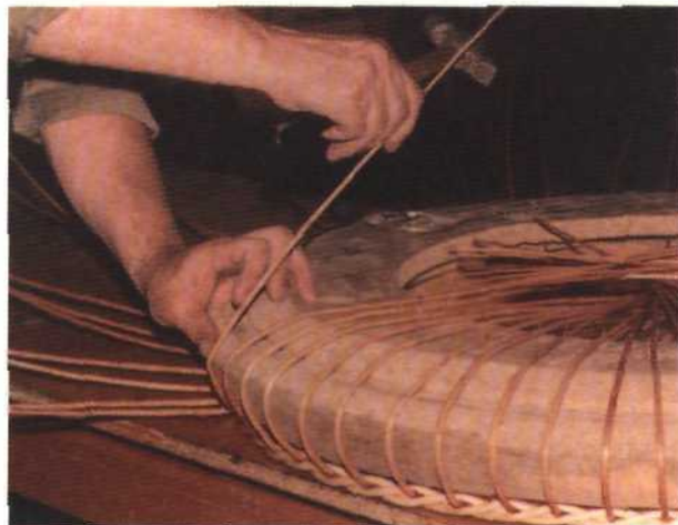
Рис. 334. Сгибание стоячков к центру столешницы через ребро формы
