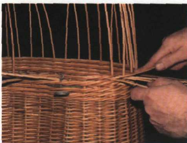
Рис. 188. Плетение третьего ряда веревочки в четыре прута поверх проволочных креплений
