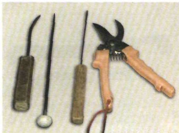
Рис. 27. Шила: загнутая (крайнее слева) и большая; прошивки и секатор
