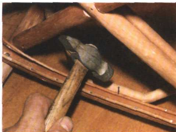
Рис. 285. Прикрепление тонких прутиков вдоль задней внутренней части сиденья
