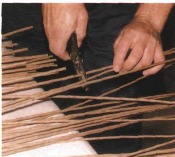
Рис. 10. Обрезка тонких верхушек прута перед раскалыванием на ленты
