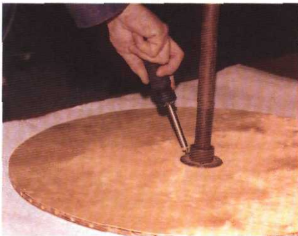
Рис. 328. Установка приспособления для вращения столешницы
