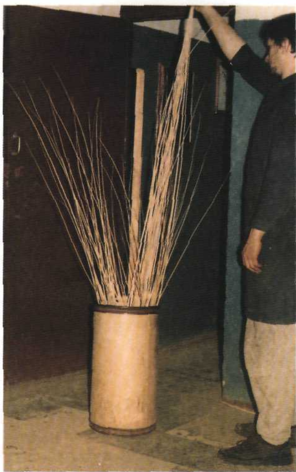
Рис. 8. Сортировка прутьев по мерной рейке
