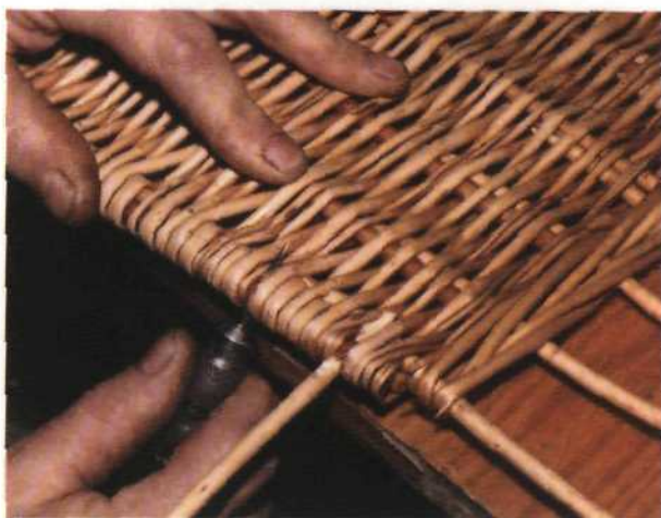
Рис. 115. Протыкание шилом отверстий в крайних палочках доньшка
