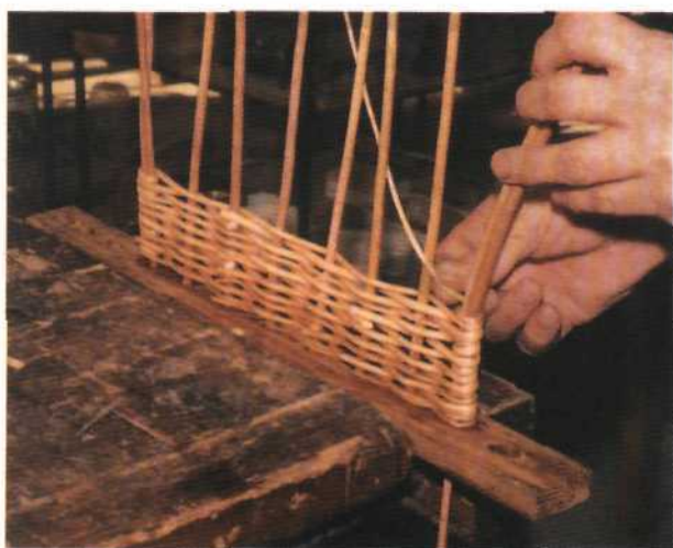
Рис. 111. Обвивание прутом крайних стоячков
