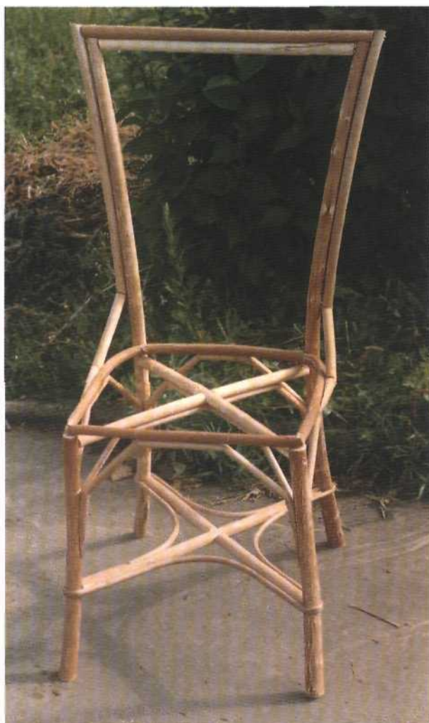
Рис. 283. Каркас стула с установленными сиденьем, крестовинами и подстрелками
