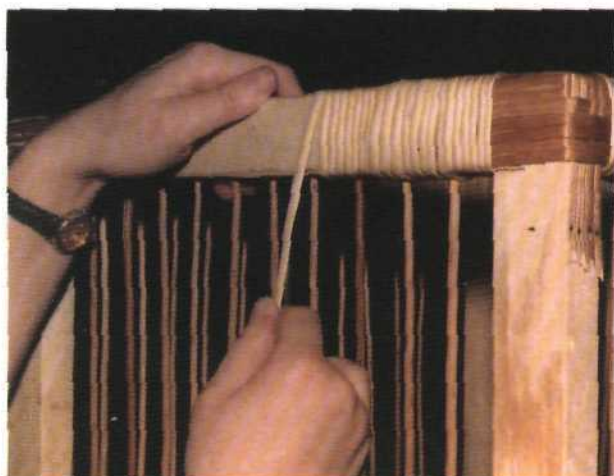
Рис. 169. Обматывание лентой верхних реек каркаса
