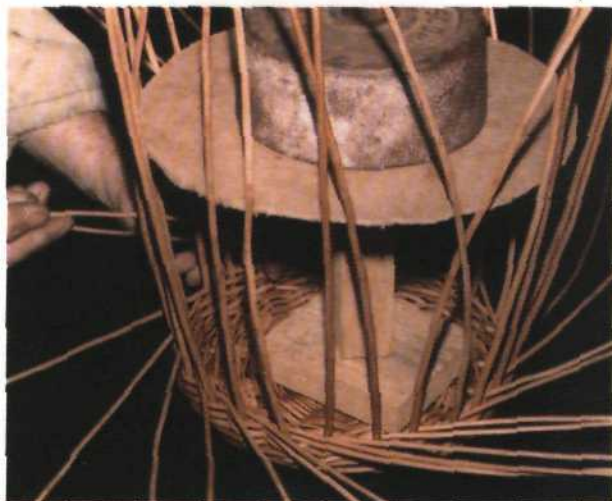
Рис. 84. Размещение определенной формы (шаблона) внутри плетения
