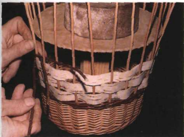
Рис. 86. Закрепление берестяных колец веревочкой из трех темных прутьев
