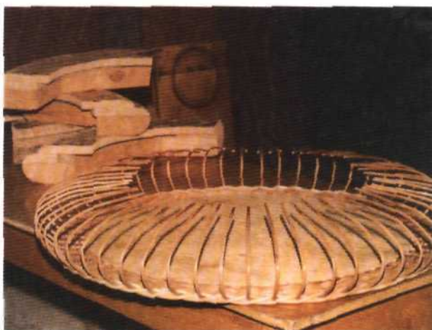
Рис. 336. Сохранение стоячками загнутого положения после удаления формы
