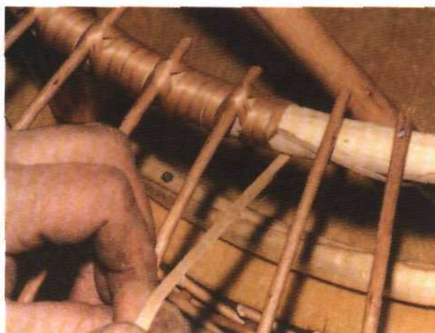
Рис. 339. Наравивание ленты в процессе обматывания нижнего обруча
