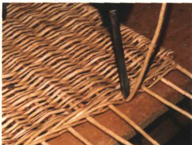
Рис. 114. Перегибание стоячков поперечных боковых стенок через отвертку
