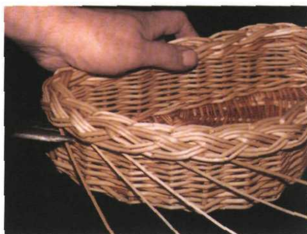
Рис. 149. Обрезка кончиков прутьев после плетения внешней косички
