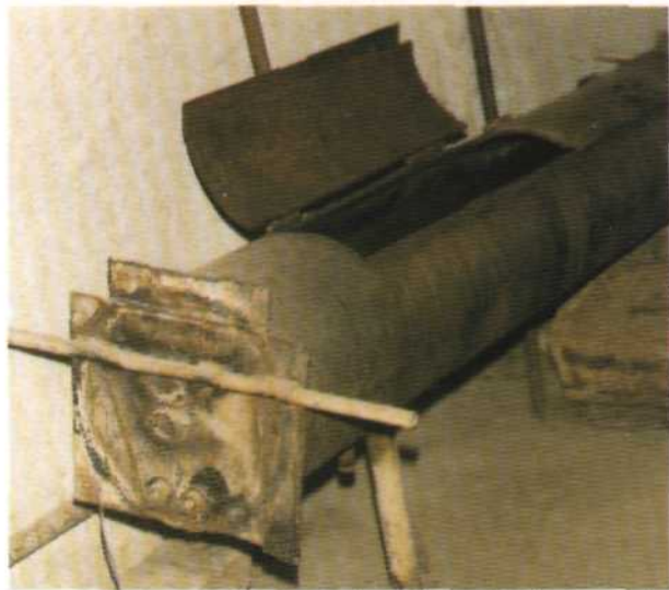
Рис. 4. Электрический котел для отваривания прута
