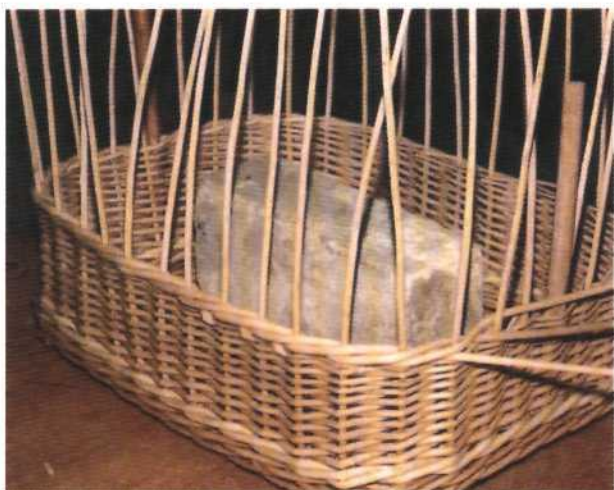
Рис. 120. Закрепление послыюного плетения простой веревочкой в три прута
