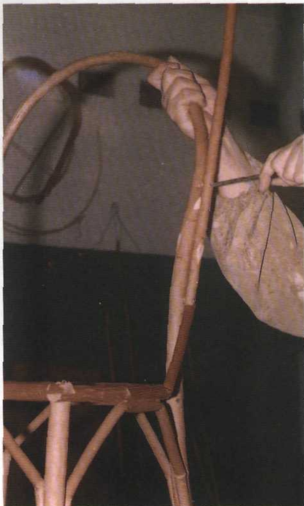
Рис. 312. Скрепление упором боковых сторон сиденья и боковин спинки
