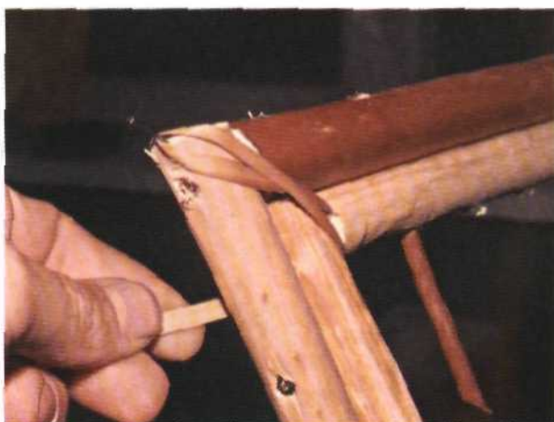
Рис. 289. Начало обматывания лентой угла спинки
