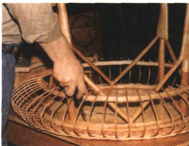
Рис. 337. Установка и прикрепление каркаса к столешнице шурупными
