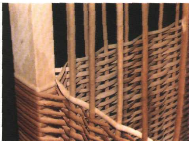
Рис. 171. Обвивка боковой рейки при выходе ленты внутрь плетения
