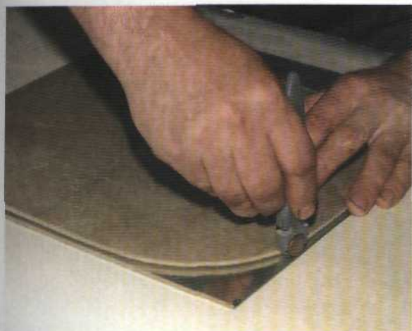
Рис. 205. Обрезка углов зеркала стеклорезом
