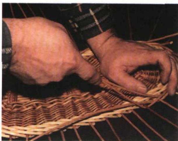
Рис. 192. Закрепление веревочкой прутьев, вставленных в крышку
