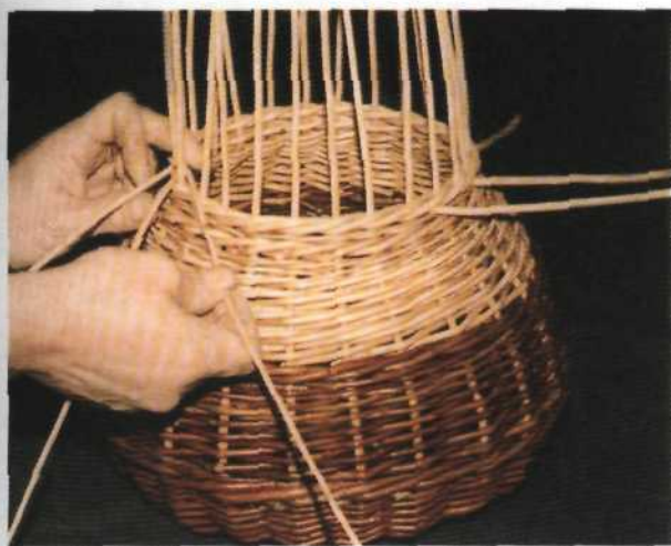
Рис. 68. Фиксирование вертикально расположенных стоячков веревочкой из трех прутьев
