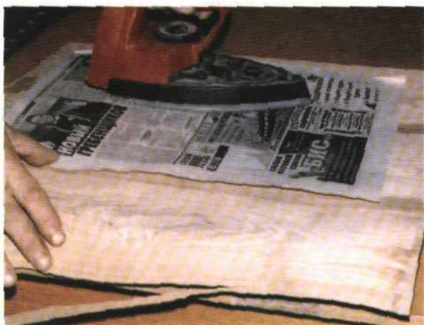
Рис. 35. Приклеивание шпона к фанерной заготовке
