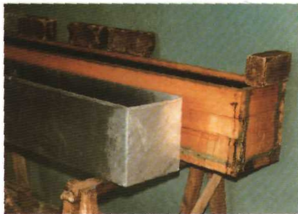
Рис. 24. Корыта для замачивания палок и прута: из оцинкованного железа (слева) и деревянное (справа)
