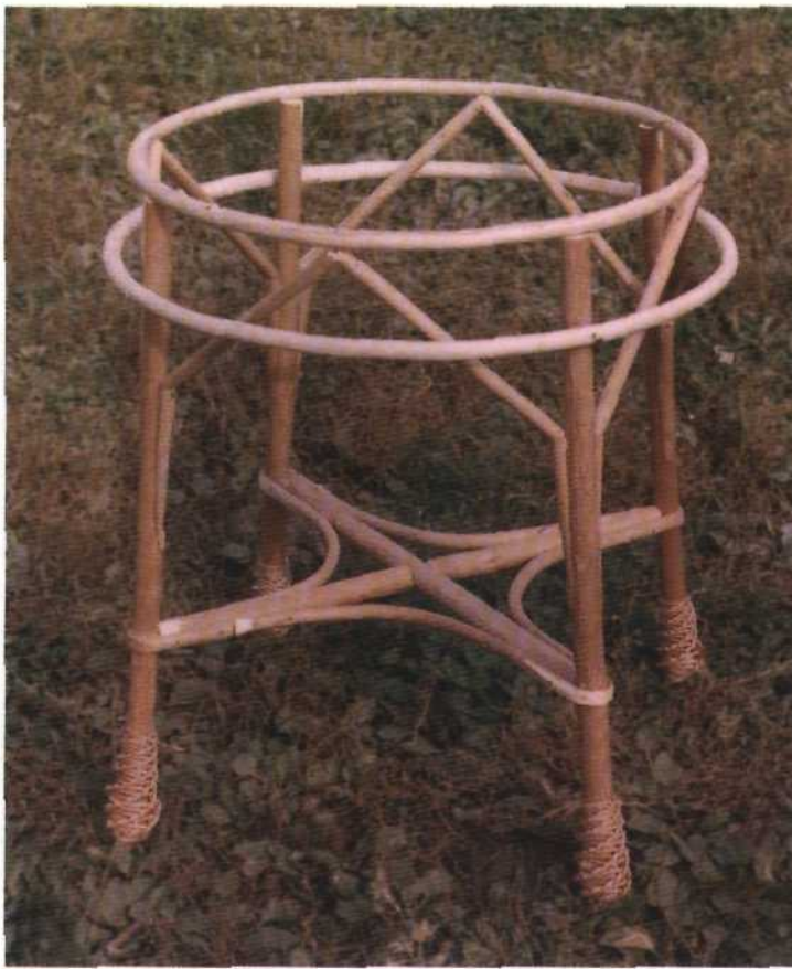
Рис. 327. Каркас круглого стола в сборе
