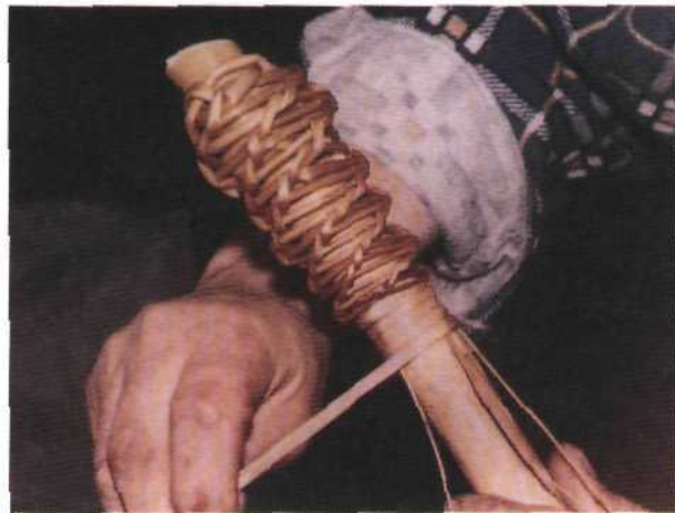
Рис. 278. Обматывание лентой (закрепление) кончиков прутьев
