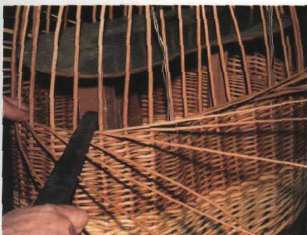
Рис. 185. Сбивание тяжелым изером послынного плетения
