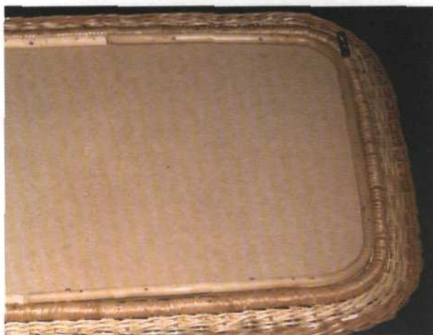
Рис. 234. Закрепление ДВП в ободке рамы дугами на шурупах
