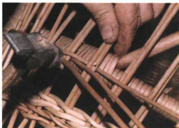
Рис. 318. Прибивание стоячков к сиденью с одновременным плетением веревочки
