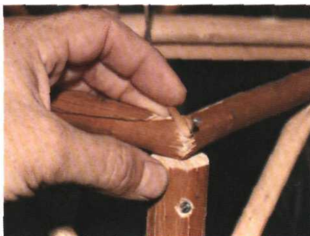
Рис. 292. Начало обматывания переднего угла сиденья
