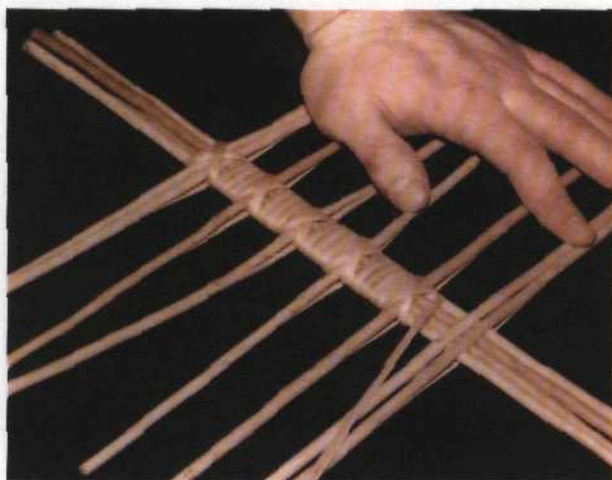
Рис. 94. Обвязывание лентой каркаса из четырех длинных и восьми коротких палочек
