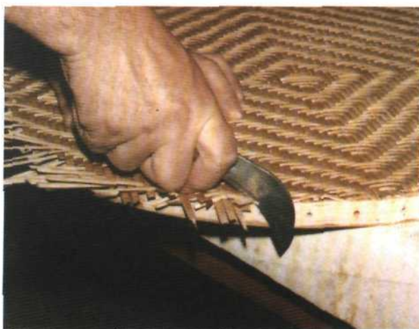
Рис. 266. Удаление выступающей за край круга-основы части ленточного полотна
