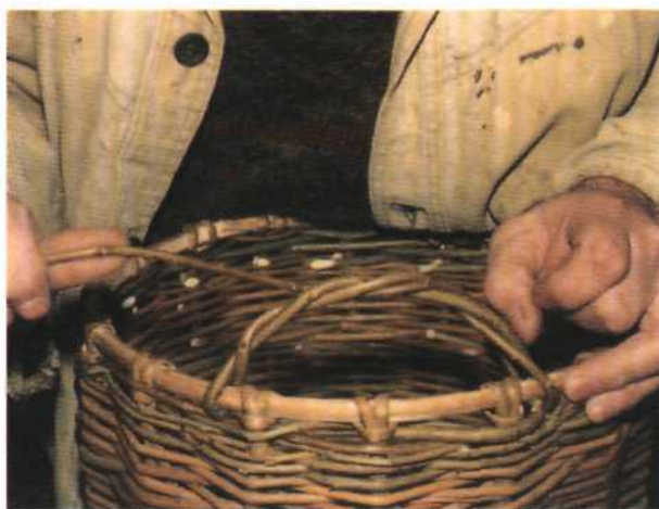
Рис. 152. Накручивание тонкого конца прута вицы на ручку
