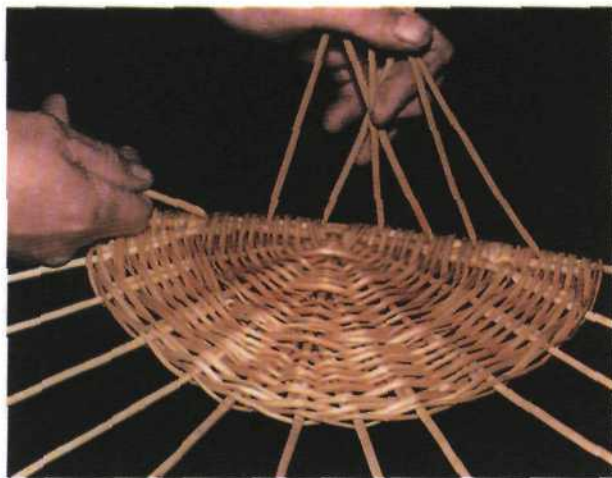
Рис. 145. Установка стоячков вдоль спаренных палочек
