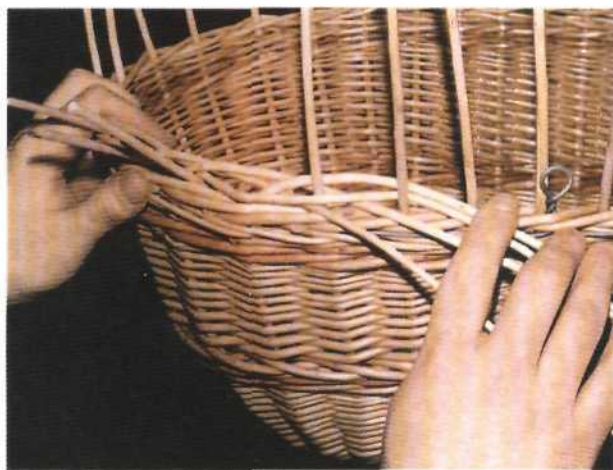
Рис. 105. Загибка четвертого стоячка с последующей укладкой рядом с первым стоячком
