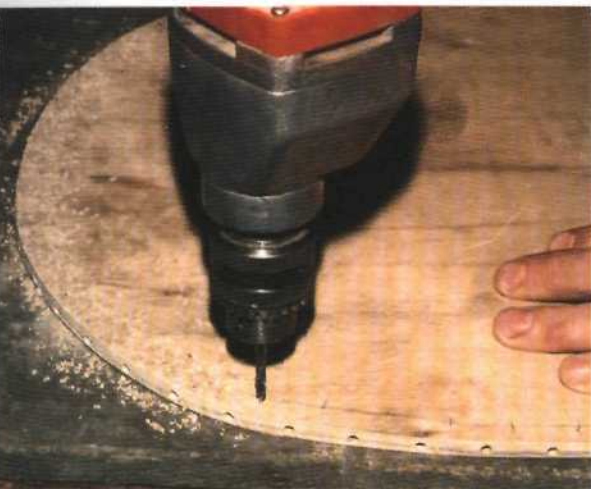
Рис. 207. Просверливание отверстий под стоячки в фанерной основе
