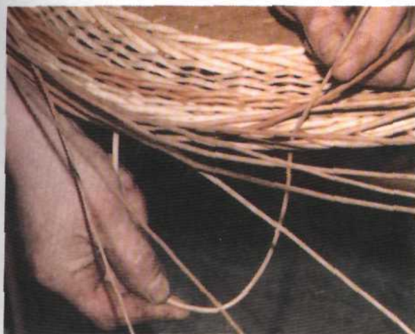
Рис. 216. Просовывание концов прутьев косички на изнаночную сторону (под косичку)
