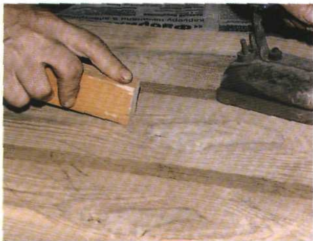
Рис. 36. Притирка поверхности шпона деревянным бруском
