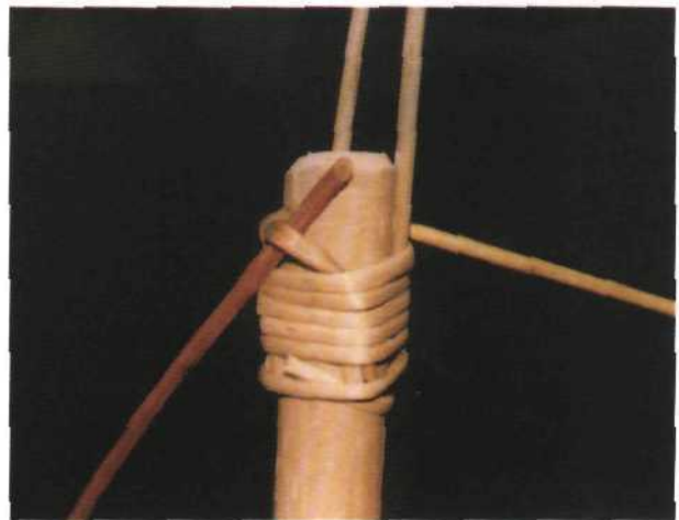
Рис. 273. Загибание по ножке второго вертикального прута
