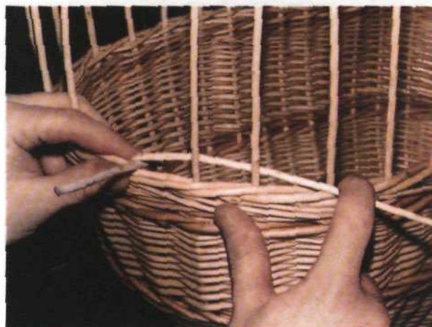
Рис. 103. Загибка стоячка за два последующих
