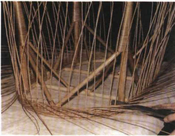
Рис. 322. Сбивание тяжелым изером послойного плетения
