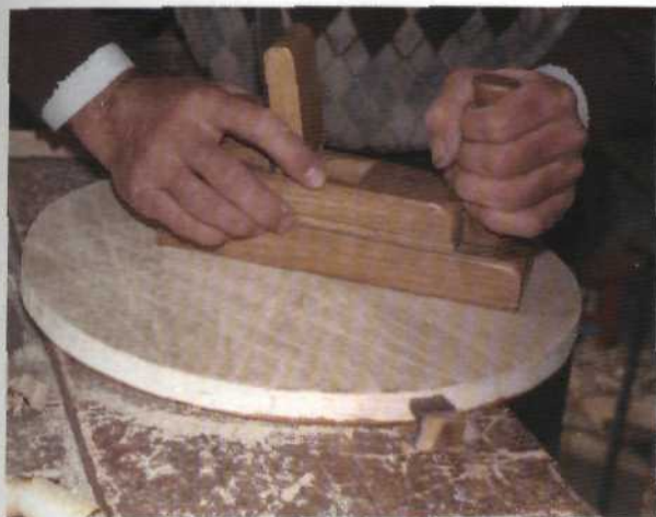
Рис. 30. Обработка поверхности фанеры рубанком-цинубелем
