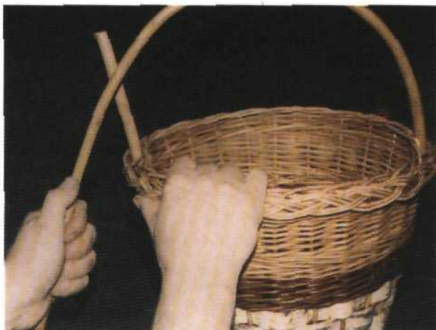
Рис. 89. Подгонка под необходимый размер палки для ручки
