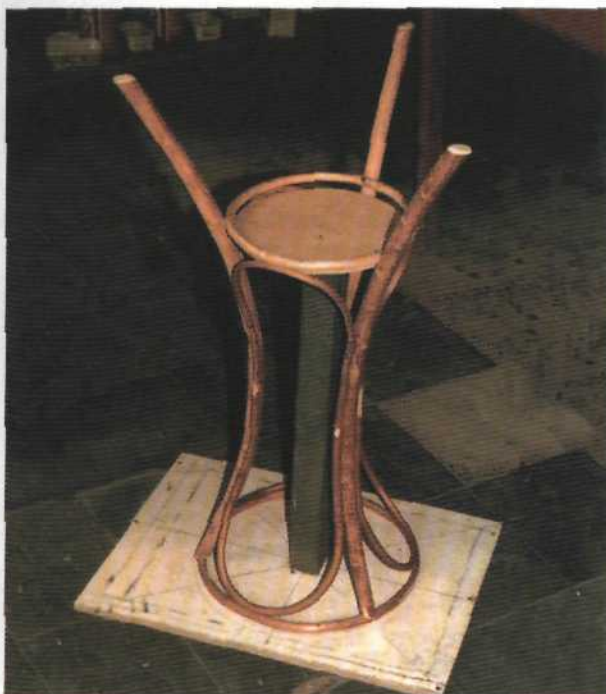
Рис. 240. Укрепление каркаса на специальном приспособлении для установки подлучек
