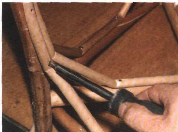
Рис. 284. Прикрепление подстрелки к каркасу шурупами
