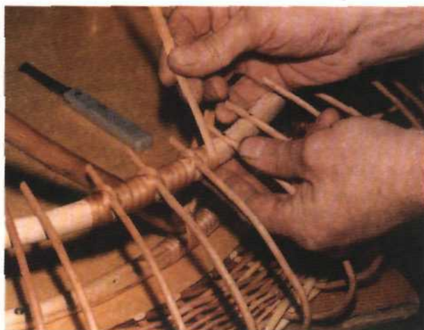
Рис. 338. Обматывание нижнего обруча совместно с загнутыми стоячками
