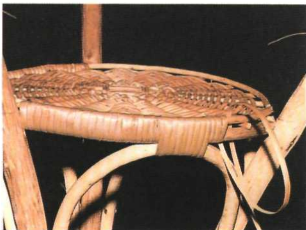
Рис. 248. Обматывание лентой обруча малого диаметра и части дуг подлучек
