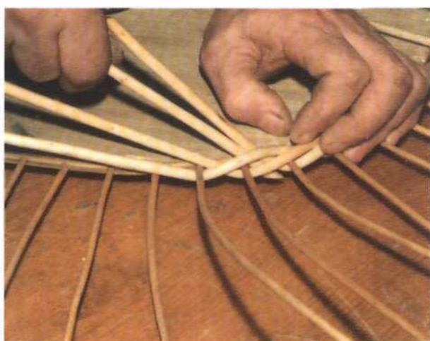
Рис. 209. Наравливание веревочки толстыми концами к толстым концам
